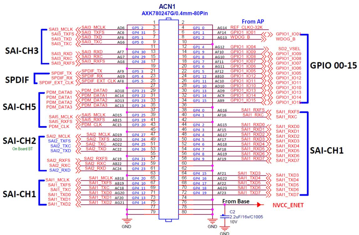
[그림1] MV8M CPU 모듈 ACN1 핀내용
