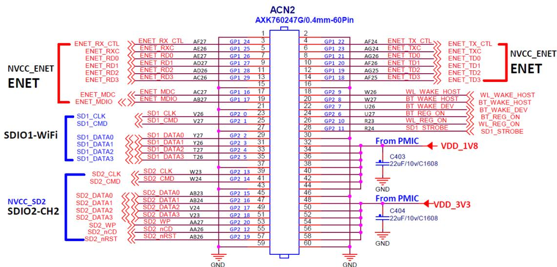
[그림2] MV8M CPU 모듈 ACN2 핀내용
