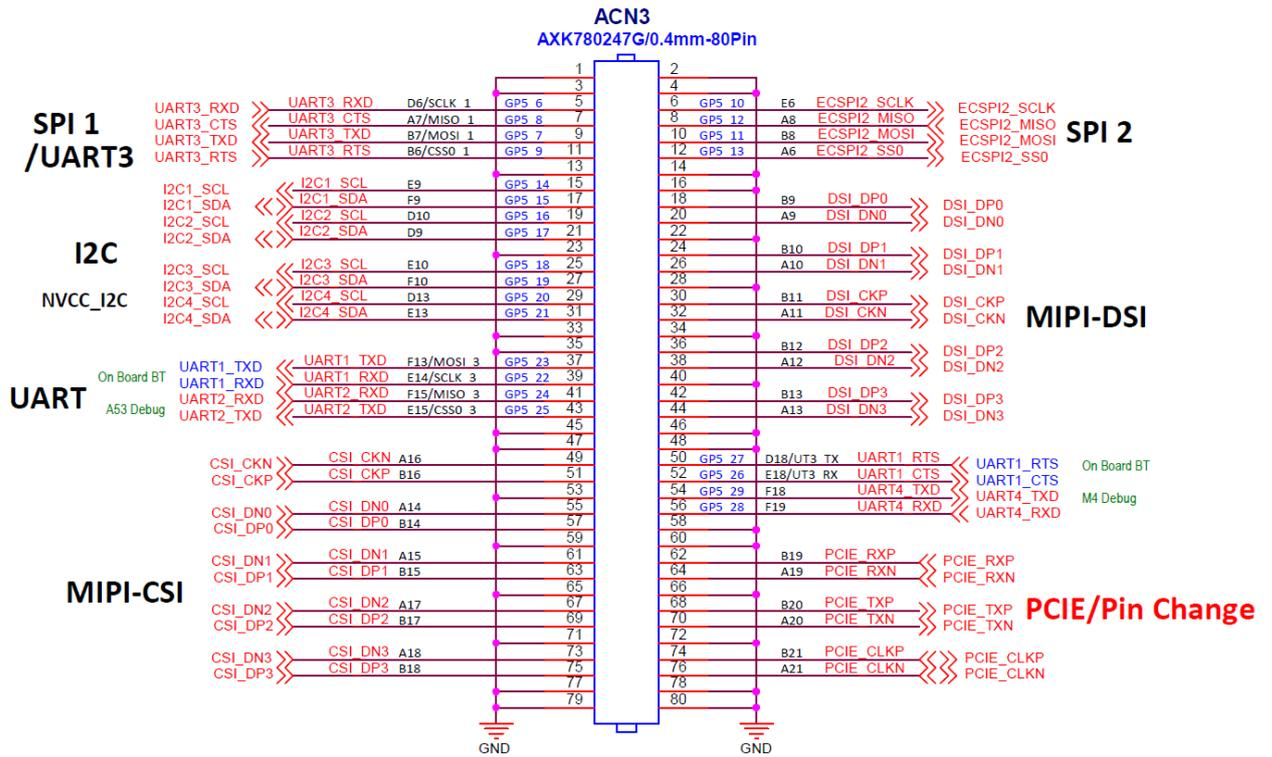
[그림3] MV8M CPU 모듈 ACN3 핀내용
